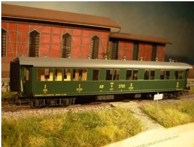
AB4ü ohne Sprengwerk, Gangseite
